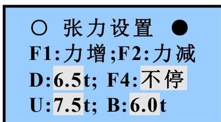
在该界面内可以设置皮带机的张紧力参数与手动调整皮带的张紧力。
