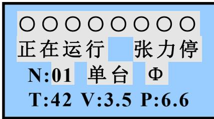
该界面为皮带控制主界面，显示皮带运行状态、张力运行状态、台号、运行方式、传感器参数等。
